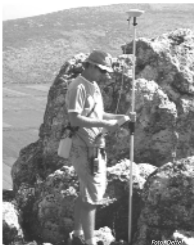
Wolf Lingemann bei der satellitengestützten Vermessung
